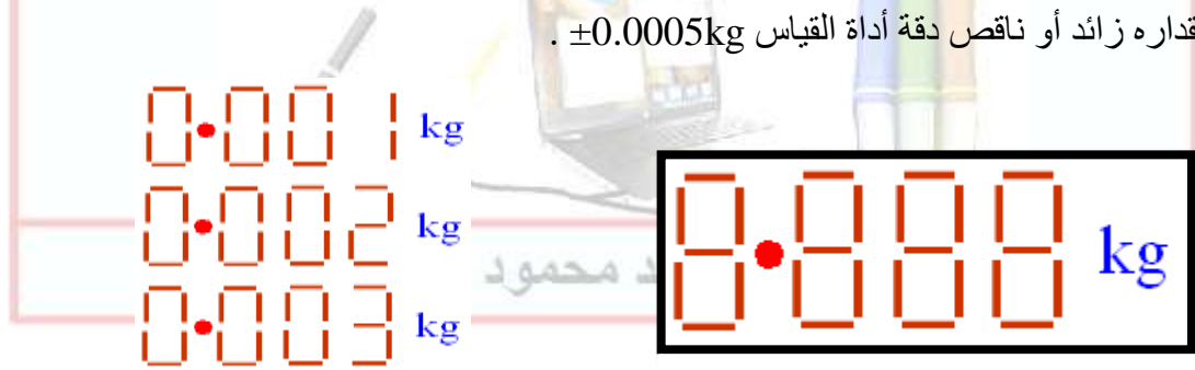
الشكل (a-3) شاشة ميزان كتلة رقمي دقته تساوي 0.001 kg .
