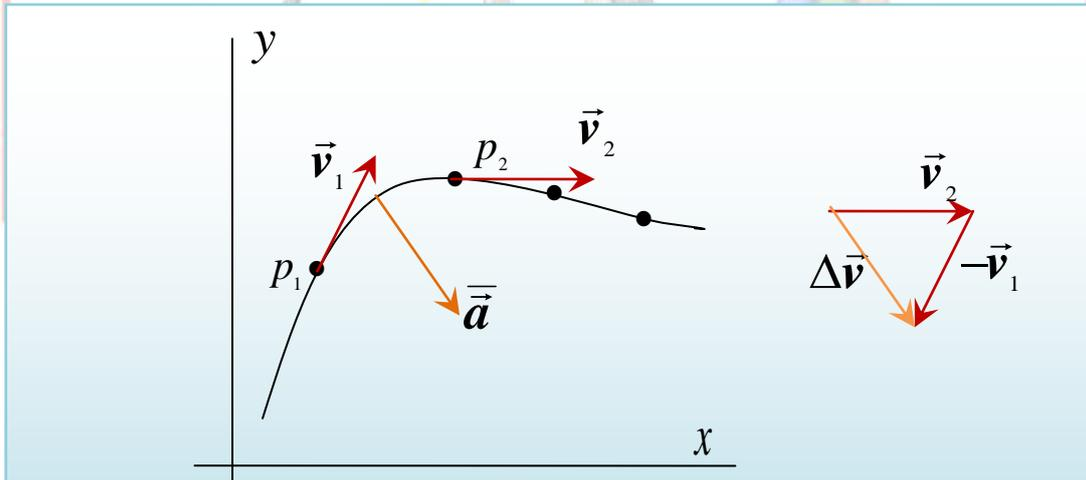
شكل (4-4) جسم يتحرك على مسار في المستوى  $xy$  سرعته عند النقطة  $p_1$  هي  $\vec{v}_1$ ، وسرعته عند النقطة  $p_2$  هي  $\vec{v}_2$ . متوسط التسارع بين النقطتين يكون  $\vec{a}$ ، واتجاهه يكون باتجاه  $\Delta \vec{v}$  ومكان تأثيره يكون عند منتصف المسار بين النقطتين.  $\Delta \vec{v} = \vec{v}_2 - \vec{v}_1$
